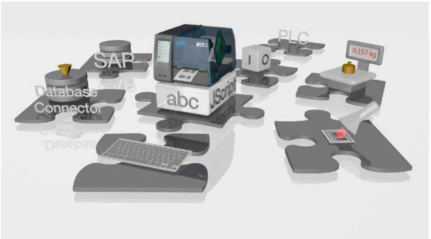
No hay ninguna impresora que trabaje sola: en un entorno productivo siempre se interconectan con otros dispositivos o redes para su control y supervisión. cab ofrece una amplia variedad de opciones para integrar la impresora en su entorno.
